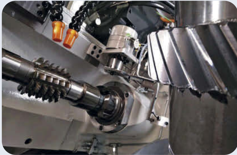
Una talladora de fresa madre, una de las máquinas de SEGI S.L.
